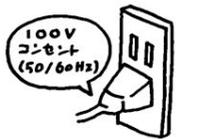
■ACコードプラグを着脱する時は必ずメインスイッチ、モデリングランプスイッチを切ってください。
