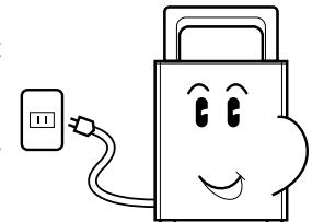
■ ストロボ電源部は使用しないときでも1ヶ月に1~2度は必ず出力を FULL にして通電をしてください。
