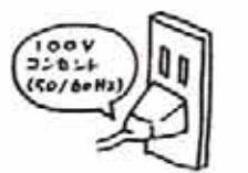
■ACコードプラグやヘッドコードプラグを離脱する時は必ず電源部のメインスイッチ、モデリングランプスイッチを切ってください。急激に大電流が流れ、ショートによる火傷、発火の恐れがあります。
