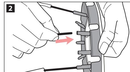
スピードリングのオートクローズボタンを矢印の方向につまみ、軸受けを正面に倒します。
